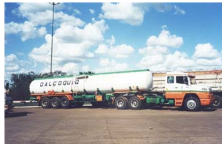
Fig 2 Cavalo mecânico + semi-reboque (Carreta de 6 eixos)
